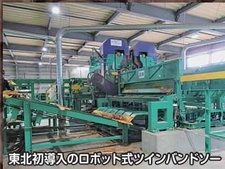
東北初導入のロボット式ツインバンドソー
